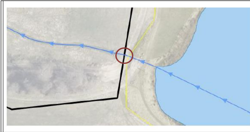
Figur 5: Krydsningspunkt, vest for Haardalen på matr. 6a Siim By, Dover. Krydsningen udføres via gravning under det rørlagte vandløb. Det beskyttede overdrev mod vest, må ikke påvirkes.
